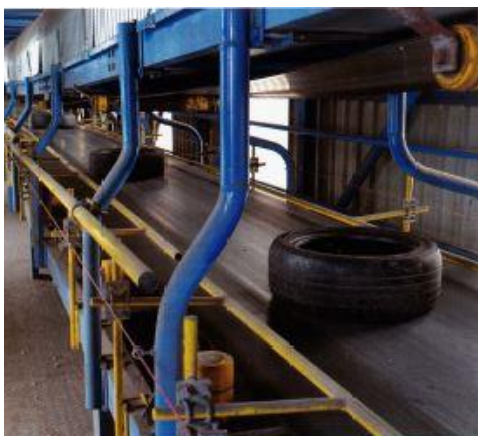
Linka na dávkovanie opotrebovaných pneumatík
